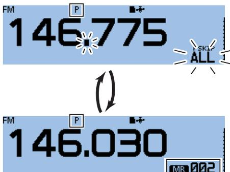
Die Speicher werden alle 5 Sek. sequenziell überprüft.
