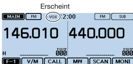
Wenn der Transceiver nicht mit einem Bluetooth®-Headset verbunden ist, steht die VOX-Funktion nicht zur Verfügung, selbst wenn bei „VOX“ die Einstellung „ON“ gewählt ist. Daher muss man unbedingt sicherstellen, dass die Bluetooth®-Verbindung zwischen Transceiver und Headset besteht.
