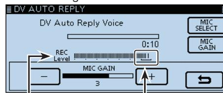
NF-Pegel-Anzeige      Mikrofonverstärkung so einstellen, dass die Anzeige des NF-Pegels diesen Bereich nicht erreicht.
