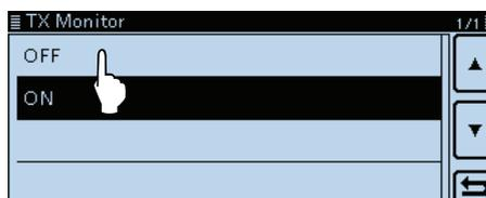
Wenn die TX-Monitor-Funktion eingeschaltet ist, hört man die aus einem Sendesprachspeicher gesendeten Signale aus dem Lautsprecher mit.
