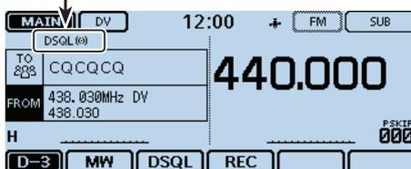
Wenn ein Signal empfangen wird, das ein passendes Rufzeichen enthält, öffnet die Rauschsperrung und das Signal ist hörbar.
