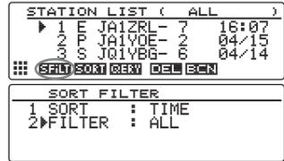
5 Den Drehregler drehen, und **[2 FILTER]** auswählen.
